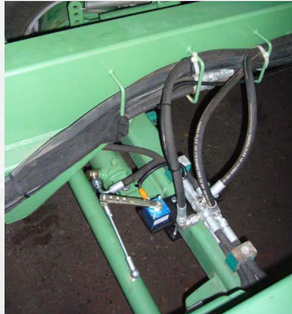
Bild links: Reflektorscheibe und Induktivgeber zur Erfassung des Geschwindigkeitssignals.
