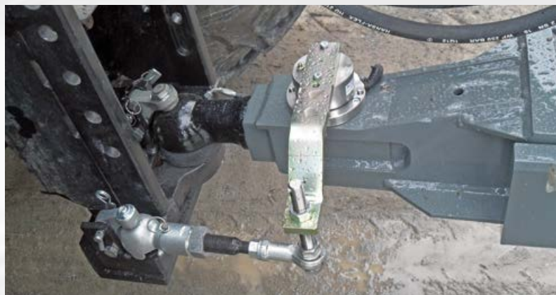
Scharmüller Kugelkupplung K80 mit Kugelkupplung K50 angeordnet nach der DIN-Norm 26402.
